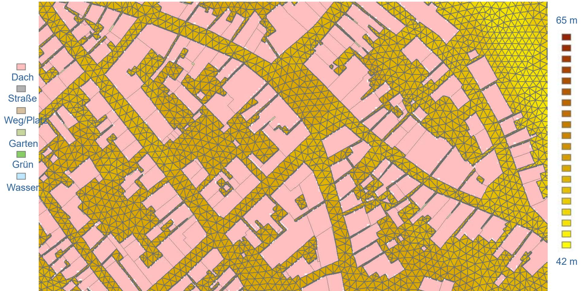
Modellaufbau: Höhengitter aus Vermessung/Überfliegung
